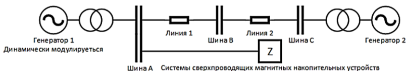
Рисунок 3. Схематическое улучшение показателей гибкой системы передачи переменного тока с использованием системы сверхпроводящих магнитных накопительных устройств
